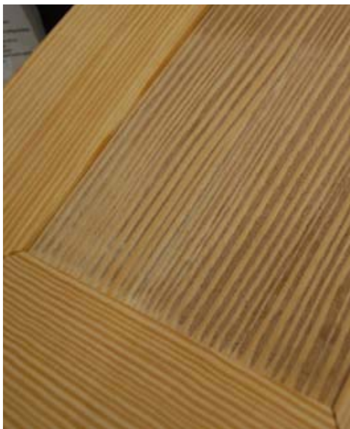
Strukturyzacja wykonana na drewnianym froncie. Fot. K. ORLIKOWSKA
