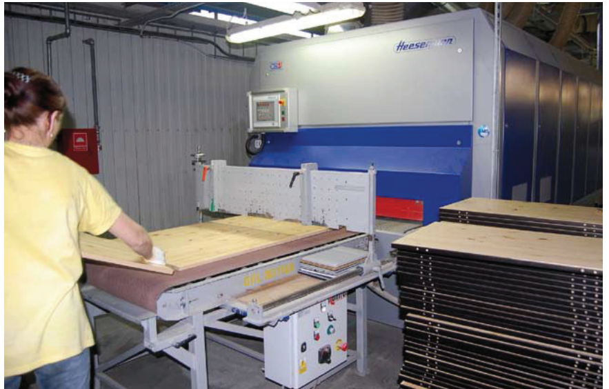
Pierwszą maszyną w linii walcowego lakierowania jest pięcioagregatowa szlifierka szerokotaśmowa Heesemann.
