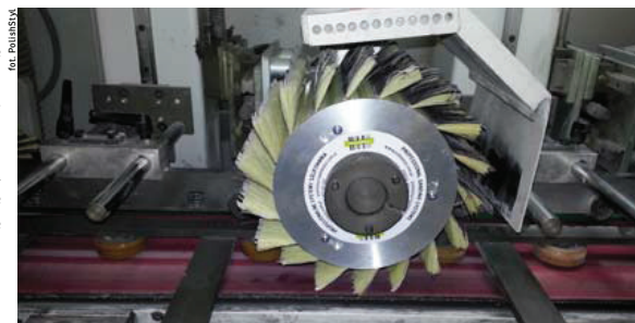
Od pewnego czasu oferta handlowa wzbogacona została o nowy rodzaj głowic szczotkujących, w których rowki wykonane są pod kątem, co powoduje, że szczotki podczas pracy bardziej się kładą.
