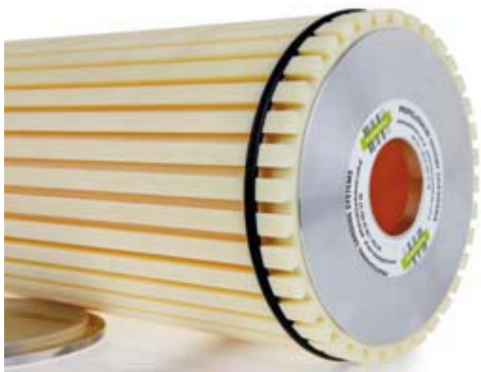
Głowice wykonywane są z rowkami prostymi lub skrętnymi, co w połączeniu z regulacją kierunku obrotów głowicy umożliwia efektywne szlifowanie całych płaszczyzn, jak i krawędzi elementów. FOT. POLISHSTYL
