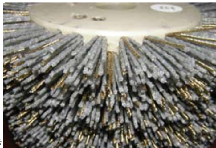
Najnowsza konstrukcja głowic do strukturyzacji to głowice typu kombi, pracujące drutem stalowym i tyneksowym jednocześnie.
