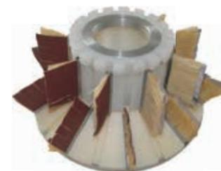
Unión del cepillo cónico y cilíndrico
