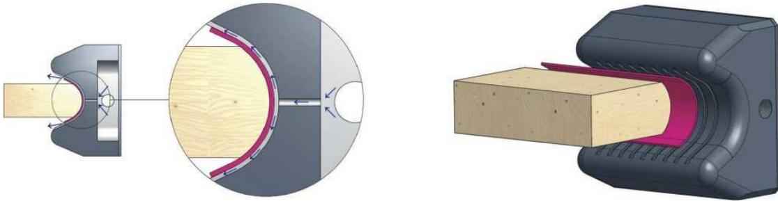
**La tecnología de zapatas ventiladas de rectificado utilizan almohadillas neumáticas entre la zapata abrasiva y la cinta abrasiva garantizando de esta forma:**
