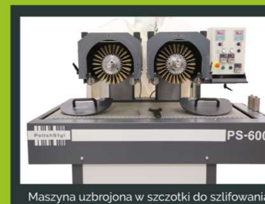
Maszyna uzbrojona w szczotki do strukturyzacji.
