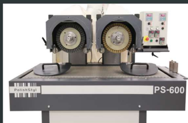
Maszyna uzbrojona w szczotki do strukturyzacji.
