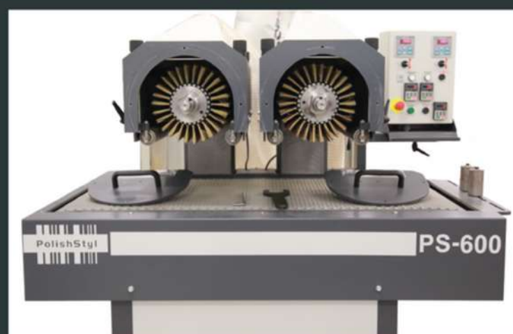
Maszyna uzbrojona w szczotki do szlifowania.
